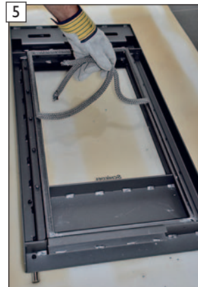
5 Alte Dichtschnur aus der Klemmschiene herausziehen. HINWEIS! Klemmschiene ggf. reinigen!
